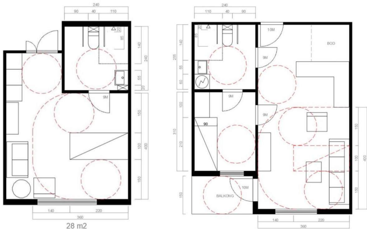
Figur 1. Mål på tilstrekkelig areal på minimumsenhet i sykehjem og toromsbolig. I boligen må seng flyttes til stua når det er behov for pleiesituasjon. Illustrasjon: Husbanken
